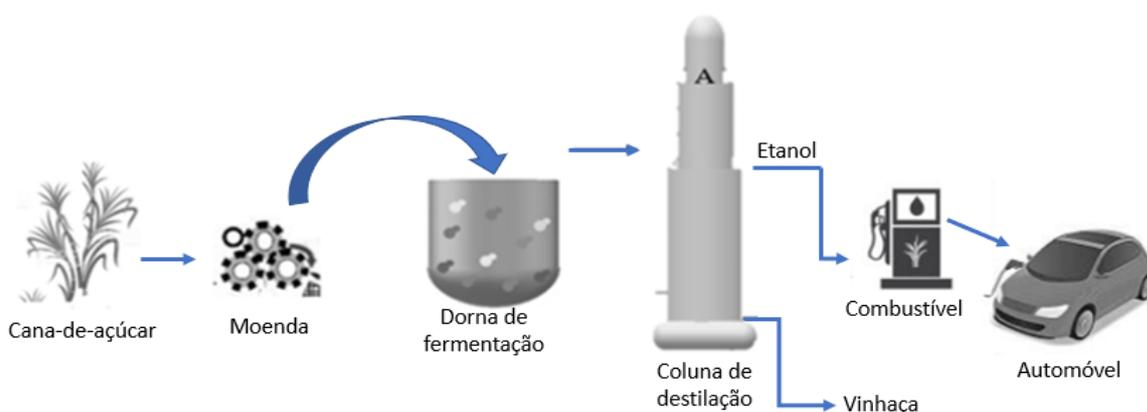
Figura 1: Rota tecnológica de produção de etanol combustível.
