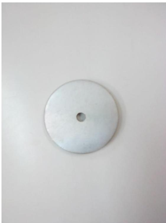
Figura 2. Corpo de prova em alumínio.
