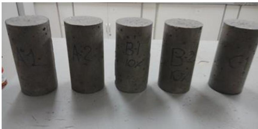
**Figura 2 –** Corpos de prova sem e com resíduos da borracha de pneu inservível.
