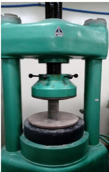
**Figura 3** – Máquina manual para ensaio de compressão.
