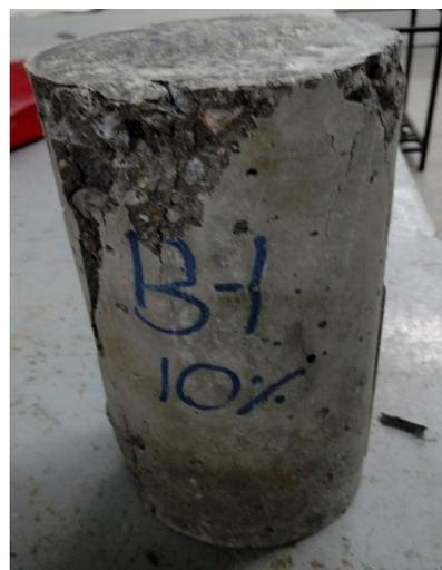
**B-1****Figura 4** – Corpos de prova rompidos sem e com adição de borracha de pneu inservível.
