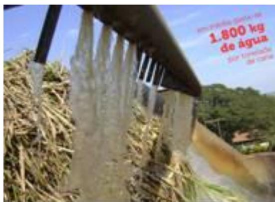
**Figura 3:** Ilustração da limpeza tradicional da cana com água na recepção (Fonte: STAB, 2012).
